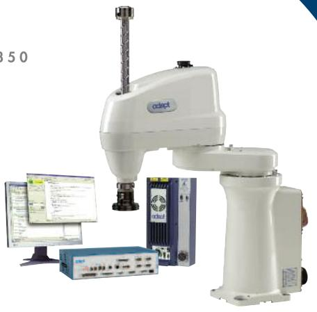
El robot Adept Cobra s350 tiene un alcance de 350 mm, permitiendo movimientos a altas velocidades y con alta capacidad de carga. Se puede utilizar para aplicaciones de montaje, manipulación, atornillado y otras aplicaciones que requieran una automatización rápida y precisa.
