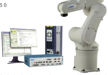
La família de robots de 6 ejes Adept Viper es una línea de robots de altas prestaciones específicamente diseñados para tareas de montaje. La velocidad y precisión de los robots Adept Viper los hace especialmente indicados también para tareas de manipulación o packaging, y para cualquier otro trabajo que requiera velocidad y precisión.
