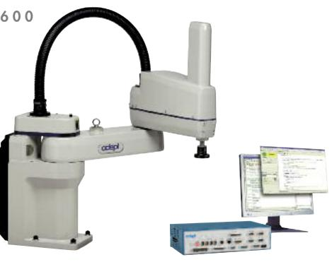
Adept Cobra s600 es un robot de altas prestaciones ideal para tareas de montaje, manipulación de materiales, packaging, atornillado y todo tipo de operaciones que requieran precisión y velocidad. Los robots Cobra están disponibles en versiones de 350, 600 y 800 mm.
